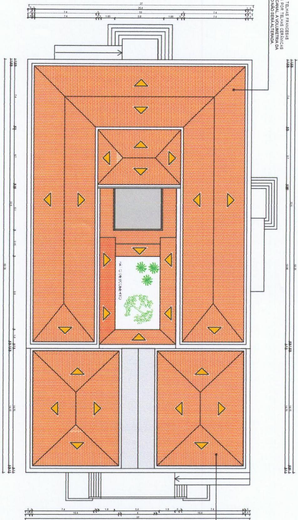
SUBSTITUIR TELHAS FRANCISAS EXISTENTES POR TELHAS CERÂMICAS TIPO CAPA CANAL. A VOLUMETRIA DA EDIFICAÇÃO NÃO SERÁ ALTERADA.
